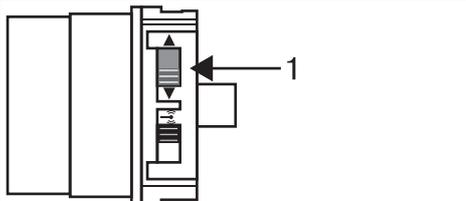
Schieben Sie den Drehrichtungsschalter (1) in die gegenüberliegende Position.
