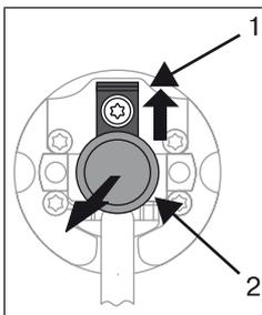
Der Steckzapfen (2) rastet beim Einschoben automatisch ein. Zum Lösen des Steckzapfens (2) das Sicherungsblech (1) nach oben schieben und den Steckzapfen (2) herausziehen.
